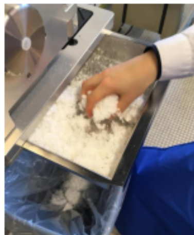
Photo 6 : Récupération du broyat de couche
