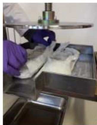
Photo 14 : Positionnement des couches dans le presseur
